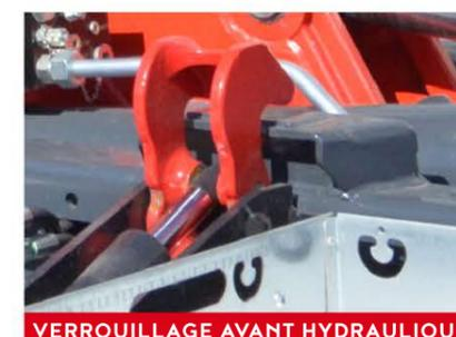
VERROUILLAGE AVANT HYDRAULIQUE
