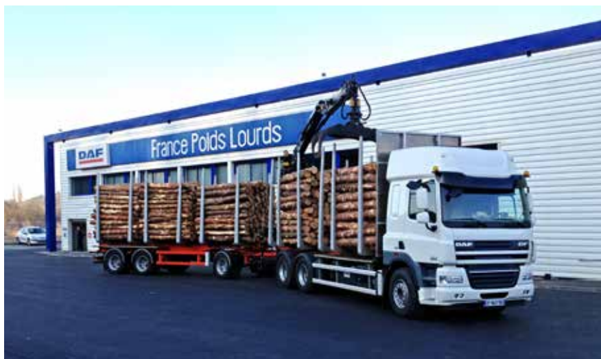
▲ L'ensemble routier porteur et remorque de TLGIC pèse 21 tonnes à vide avec la grue embarquée. Grâce à sa dérogation, il transporte 36 tonnes de bois rond.
